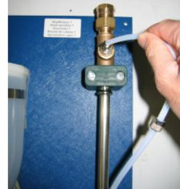
Beim ersten Auffüllen des Duftstoff-Behälters gelang automatisch Luft in den Pumpenkopf. Um eine sichere Funktion der Pumpe zu gewährleisten, muss eventuell diese entlüftet werden. Dazu muss der Pumpenschlauch vom Dosierventil abgezogen werden (s. Bild) und an der Steuerung auf Test Pumpe geschaltet werden. Bei jedem weiteren Nachfüllen von Duftstoff muss die Pumpe nicht mehr entlüftet werden!
